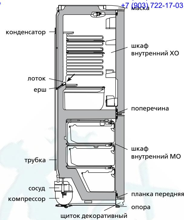
Рисунок 4 – Схема слива талой воды из ХО
